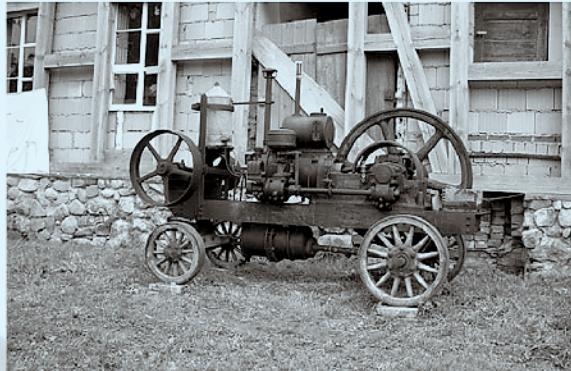
Stationärmotoren sind Motoren, die zum Antrieb von landwirtschaftlichen Geräten wie z. B. Dreschmaschinen genutzt worden sind. Zum Teil haben diese Motoren Jahrzehnte abgestellt oder vergessen in Scheunen gestanden, weil sie im Rahmen der technischen Entwicklung durch Elektromotoren abgelöst worden sind. Es gibt viele interessierte Technikbegeisterte, die es sich zur Aufgabe gemacht haben, diese alten Maschinen wieder zum Leben zu erwecken.
